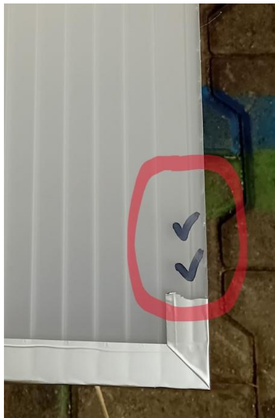
Rys. 38 Sposób oznaczania strony UV-odpornej płyt poliwęglanowych.
