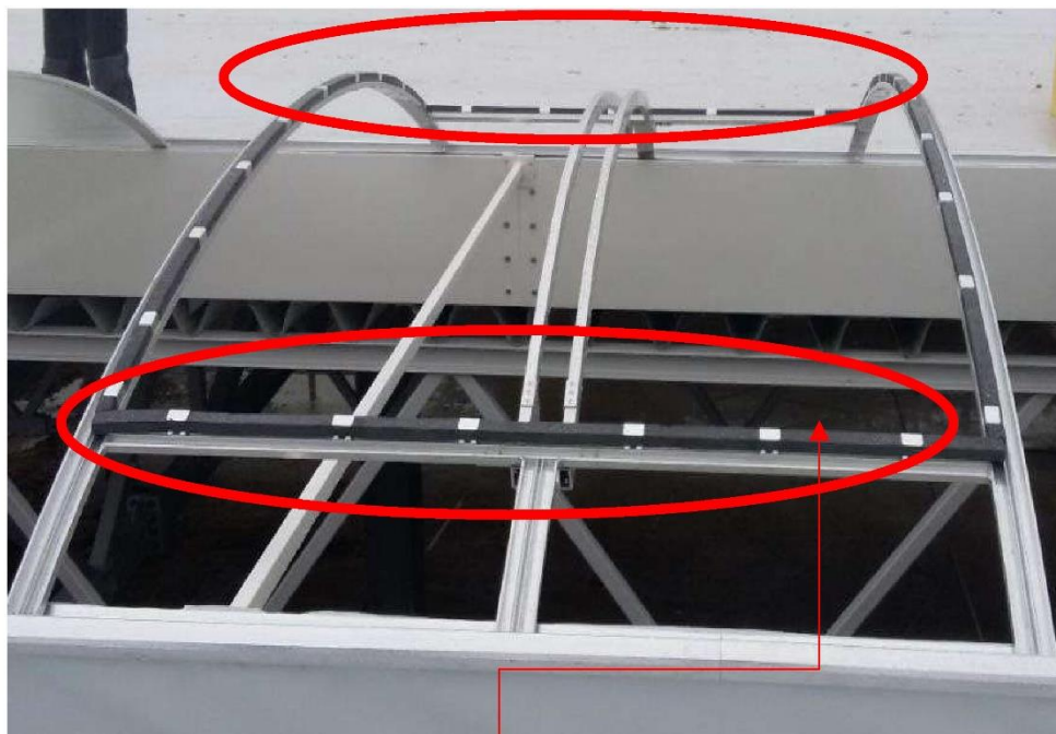
Rys. 48 Sposób rozmieszczenia konsol na pająku.
